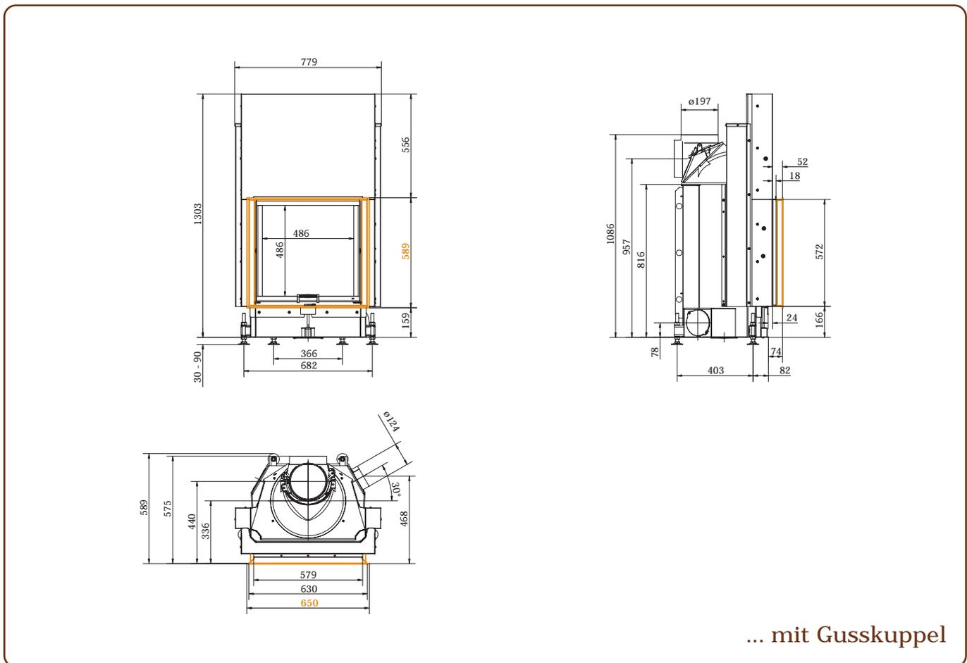
Geräte-Anbaukante: 572 x 579 mm | optionaler Blendrahmen (orange markiert), montiert an Anbaukante
